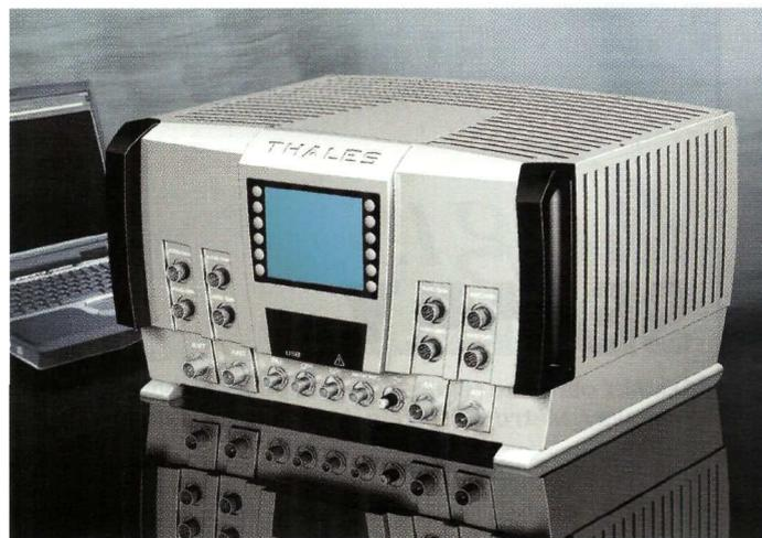
Le "Software Radio Node" : véritable commutateur mobile IP (Internet Protocole) reliant 4 canaux radio programmables pour interconnecter les bases installées hétérogènes.
