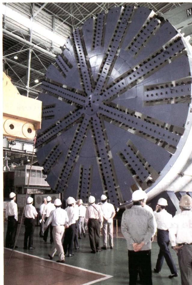
*Tunnelier : machine foreuse qui creuse la roche sans utilisation d'explosifs et construit la voûte du tunnel. Sa longueur peut atteindre 200 m, sa largeur jusqu'à 15 m.*
