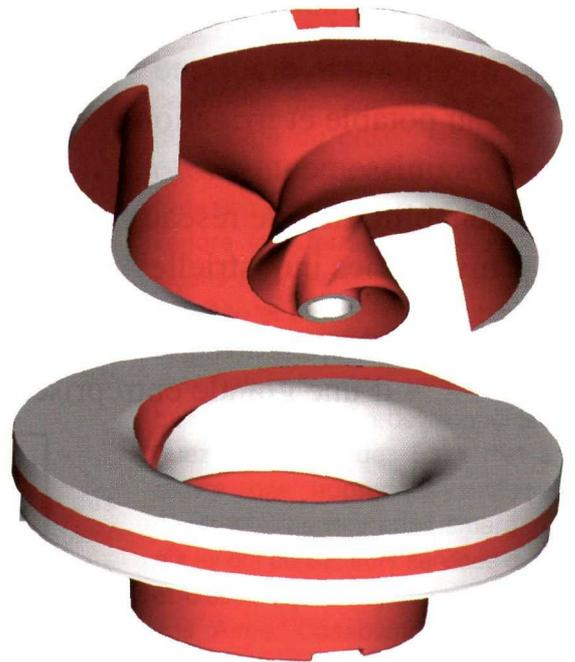
Le profil de la roue multicanaux associé à celui de la gorge spéciale d'entraînement pratiquée sur le fond de la volute constituent un système hydraulique autonettoyant qui rend la pompe pratiquement incolmatable. Ce design étudié par les ingénieurs suédois de FLYGT fait l'objet d'un dépôt de brevet international.
