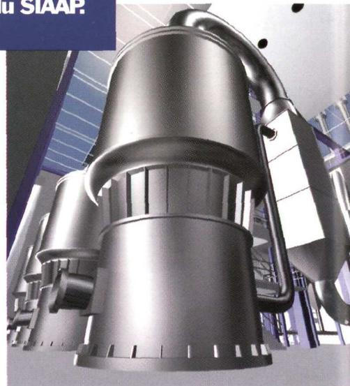
Les boues issues du traitement des eaux subiront un épaissement puis une déshydratation par centrifugation. Une partie servira d'engrais pour l'agriculture, une autre partie sera incinérée dans des fours.
