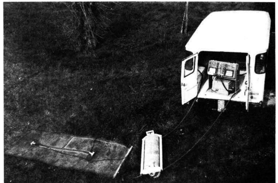
Fig. 2 - Quadripôle pour la prospection électrique.
