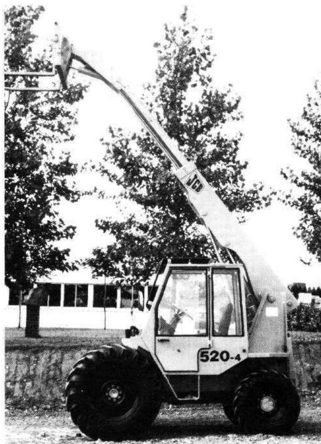
Puissants, maniables et sûrs, les **TELESCOPICS JCB** sont des engins robustes : bâtis sur un châssis monobloc, ils sont équipés de la ligne motrice éprouvée sur les chargeurs-pelles JCB : moteur de 72 cv, boîte synchronisée, inverseur hydraulique et convertisseur de couple assurent même en terrain difficile une conduite souple et des conditions de travail performantes.
