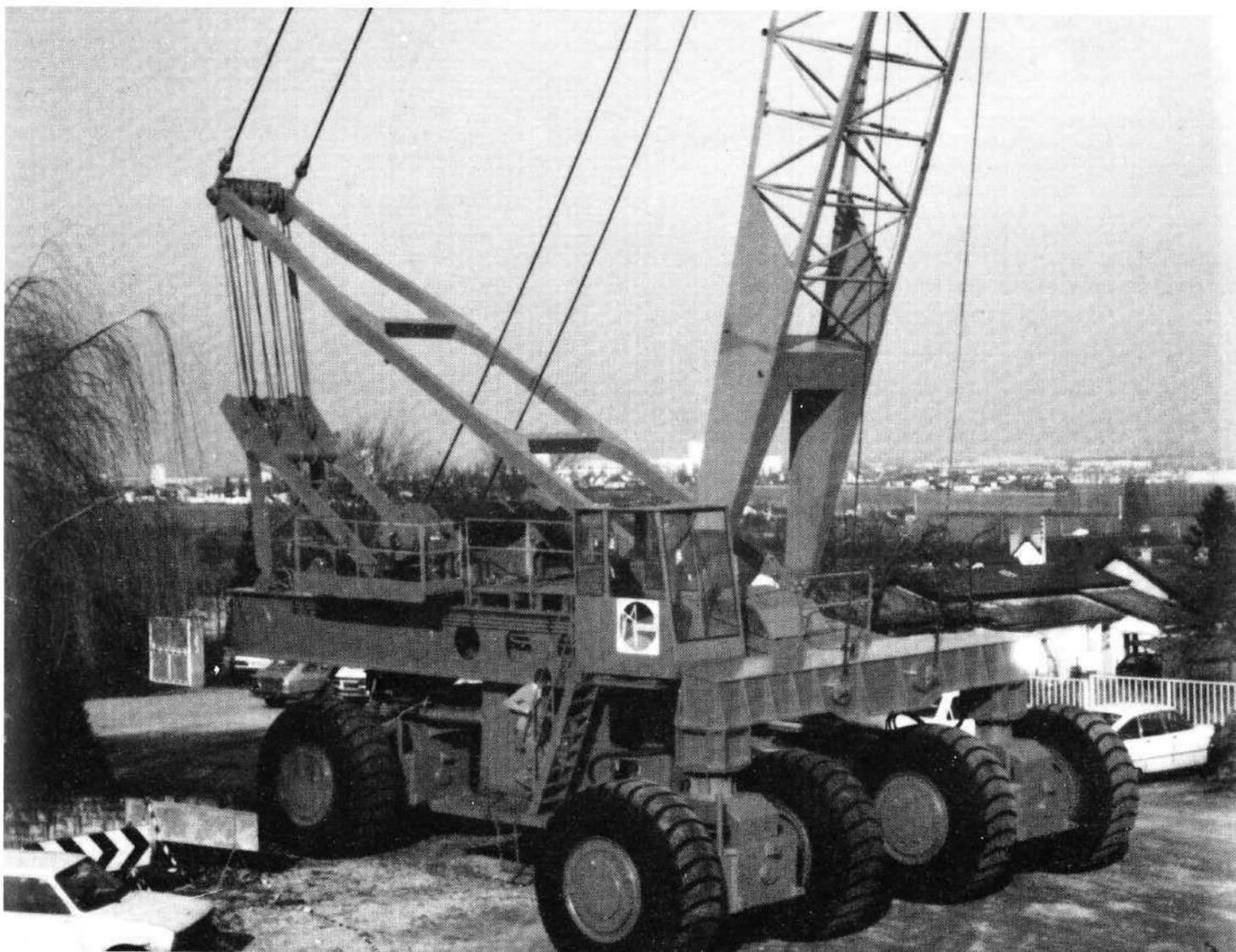
Fig. n° 4 : Vue partielle du levier en fin de consolidation dynamique créé au Groupe Ménard et permettant de générer des impacts de 700 t x m chacun.
