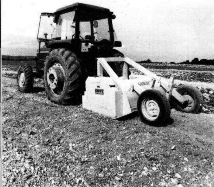
Une gamme complète de broyeurs de 1 m à 2,35 m de largeur de travail, permettant d'équiper des tracteurs de 60 cv à 200 cv.
