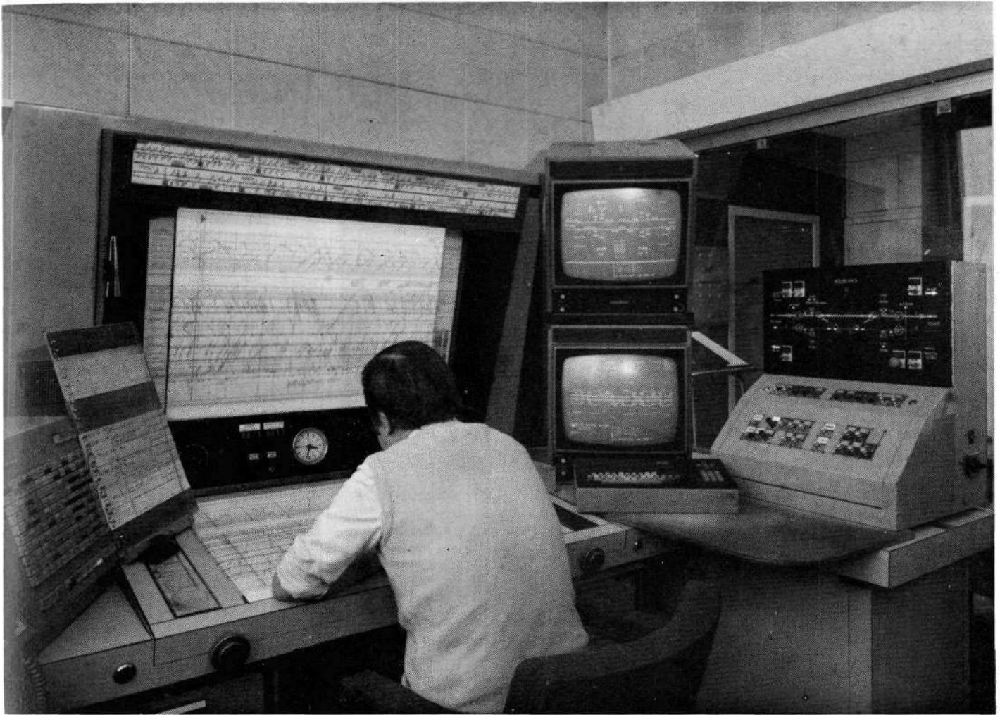
Poste central du système de Gestion d'Installation Permanente de Contre-Sens (I.P.C.S.) piloté par ordinateur, sur la ligne de chemin de fer entre Blois et Tours.
