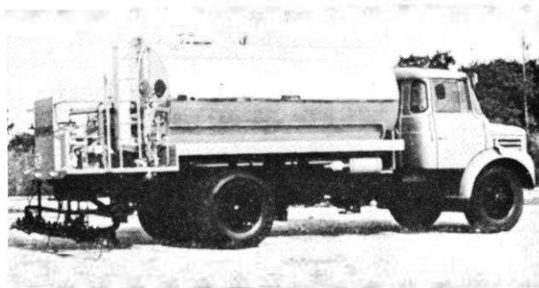
Équipement épandeur à transmission hydrostatique
