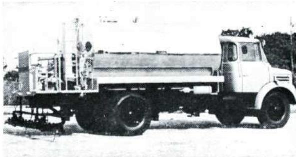
Equipement épandeur à transmission hydrostatique et rampe à commande pneumatique
