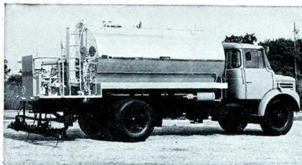
Équipement épandeur à transmission hydrostatique
