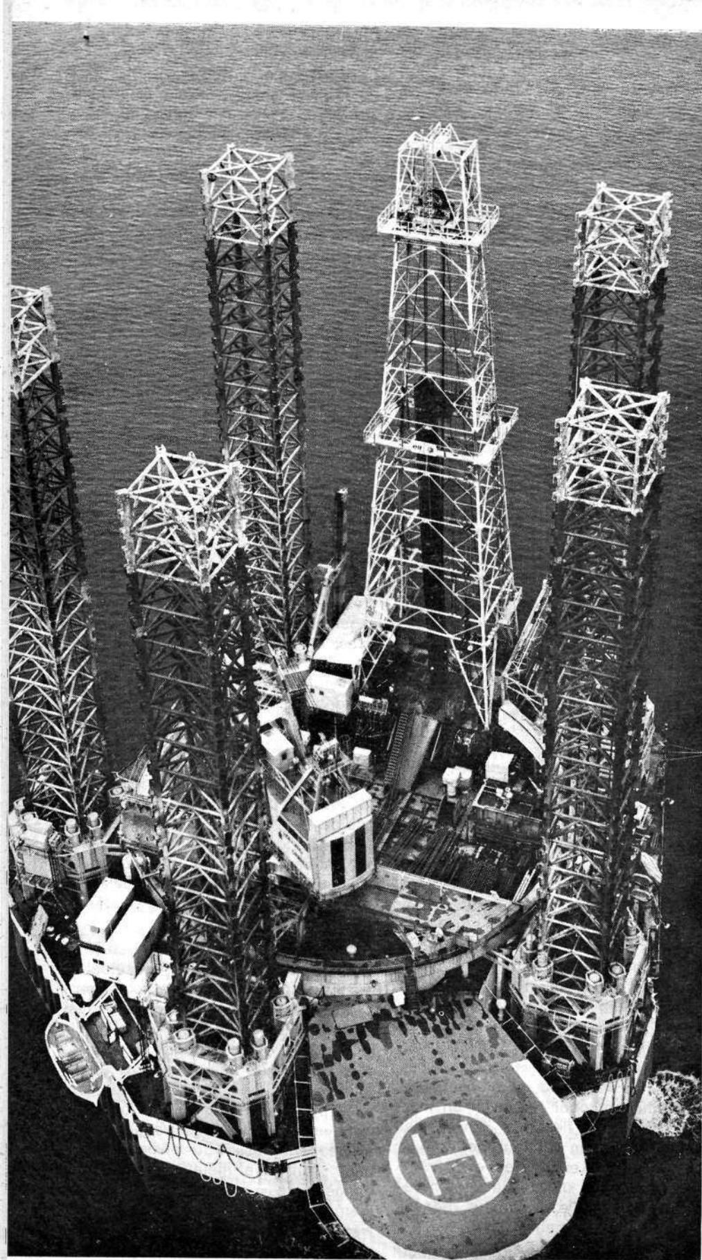
Plate-forme autoélévatrice « Ile de France » en position de forage.
