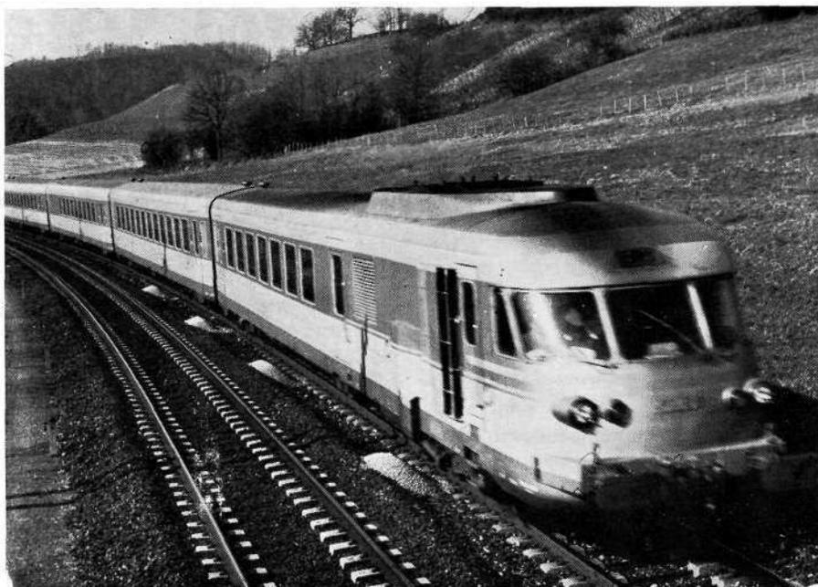
Rame automotrice à turbine à gaz RTG
